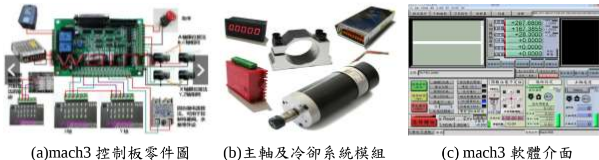
圖 10. 自組 CNC 機台重要之零組件模組
