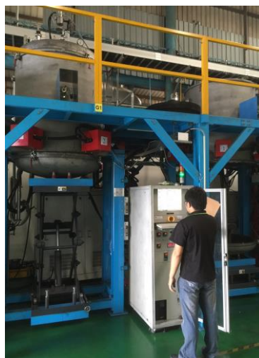
石墨負極材料表面改質之主要設備—石墨化爐
