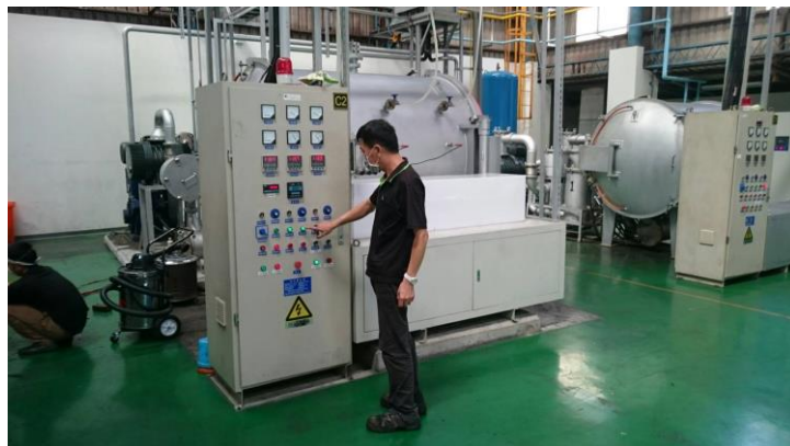
鋰電池新型硬碳負極材料表面改質之主要設備—碳化爐
