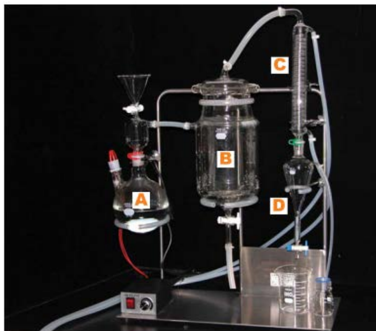
水蒸汽蒸餾法香草植物精油萃取設備
