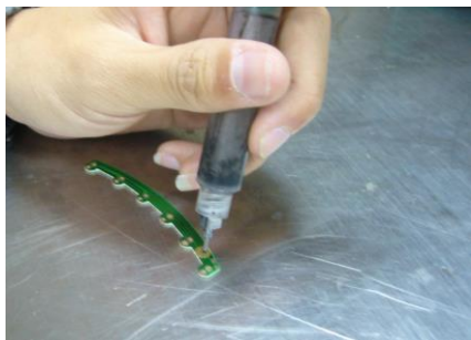
(6) 將 LED 燈銲接在電路板上
