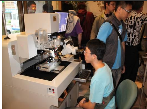
學生實際學習操作晶片打線機台
