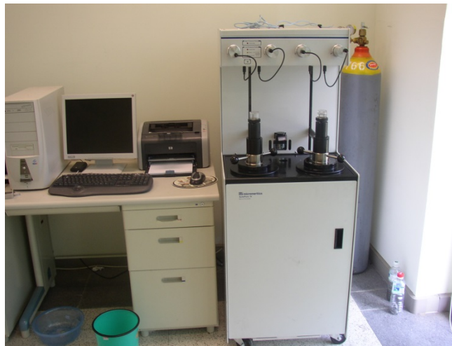
圖 4 Autopore 9500 壓汞孔隙儀
