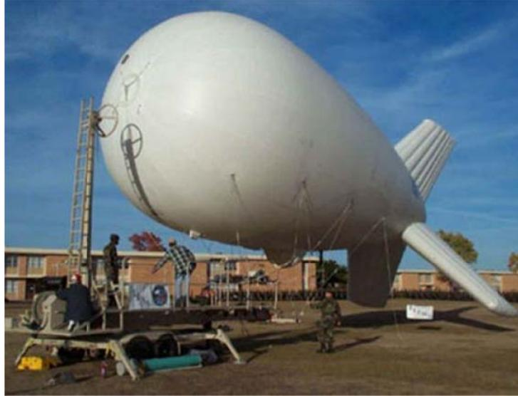
圖 7. 繫留式浮空器雷達系統(TARS)
