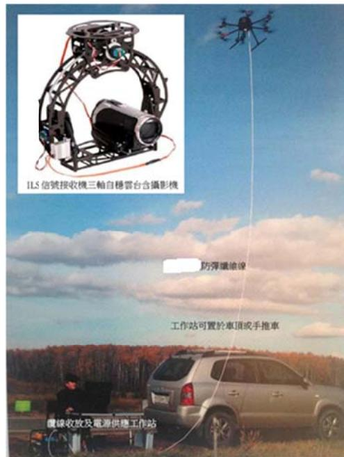
圖 58. 纜線繫留於多軸式遙控飛機與車輛間示意圖
