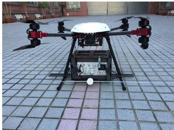
圖18(c). 多軸式遙控飛機+ILS信號接收機
