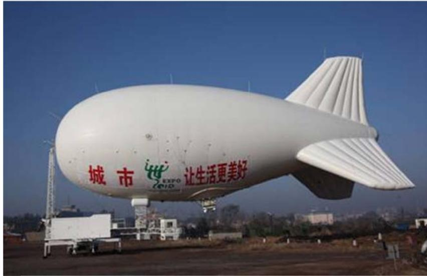
圖 10. 機動式繫留氣球系統
