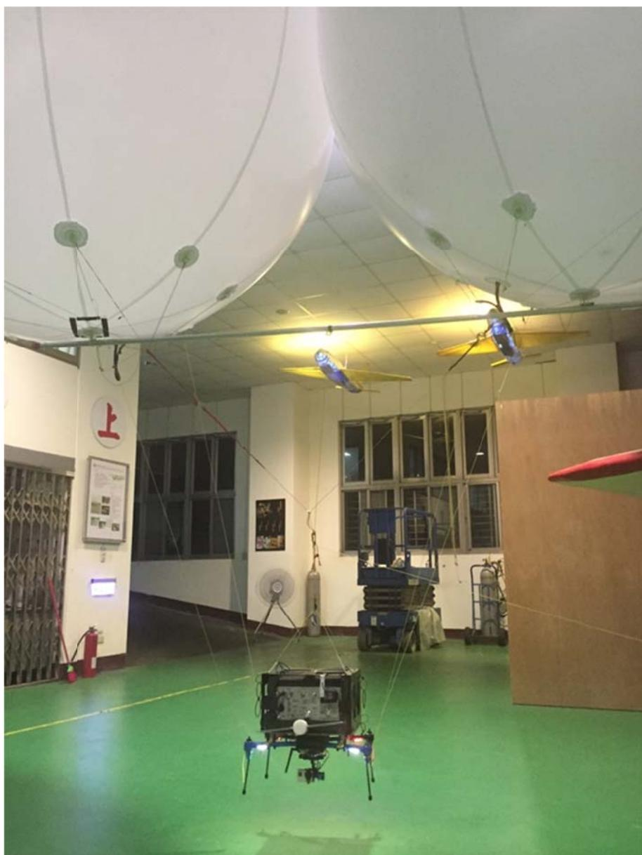
圖 46. 繫留式航空用氣球+ILS 信號接收機
