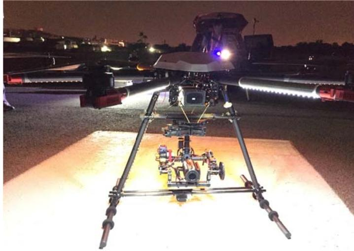
圖 54. 多軸式遙控飛機+攝影雲台
