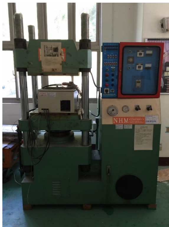
圖29、製備碳纖維複材積層板關鍵設備-熱壓成型機（設備來源：中華科技大學）
