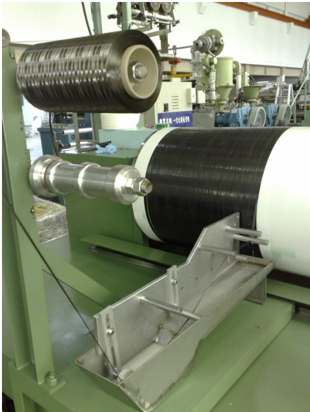
圖28、製備纖維預浸材之關鍵設備-滾筒式纖維纏繞機（設備來源：中華科技大學）
