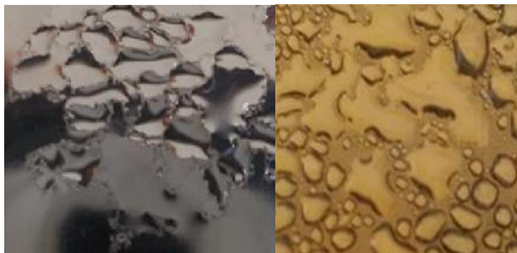
圖 15 表面平放( \alpha = 0 )冷凝可視化結果圖
