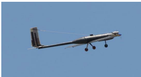
圖 12 無人機高攻角飛行測試圖
