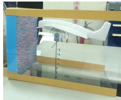
圖 5 簡易型風洞之蜂巢式結構
