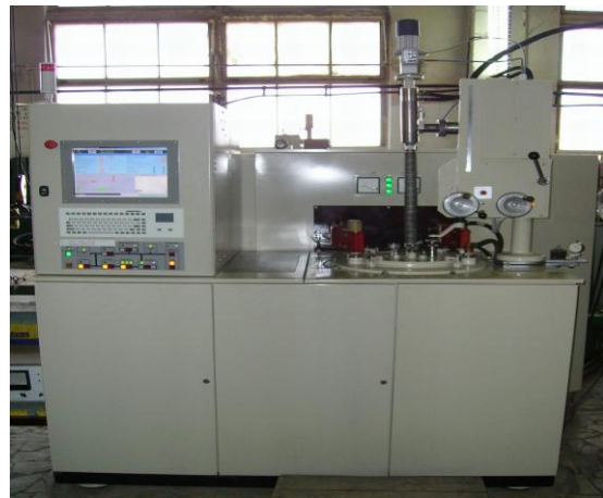
新型 45 Kg 級機台 重量：2160 Kg 機台尺寸：3m(L) x 3m(W) x 2.7m(H)
