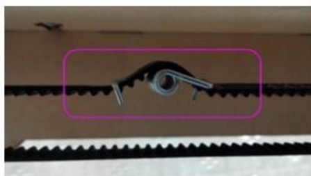
(a)傳統以彈簧夾式的拉緊裝置
